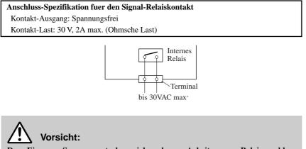
Den Eingangs-Spannungsstecker ziehen bevor Arbeiten am Relaisanschluss erfolgen. Fehlerhafter Anschluss kann zu Defekten an der QR-6560 führen.
